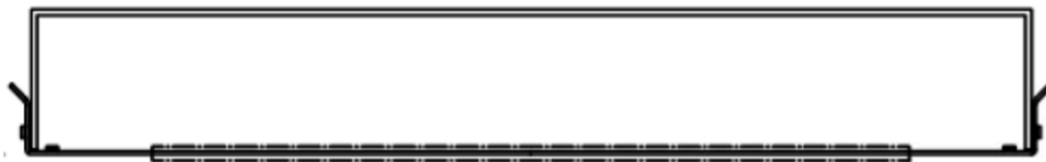
COMAX P Kastenbreite 220 Abdeckung Zellulose / PVC; Endkappe Styropor / PP Kastenhöhe 30mm
